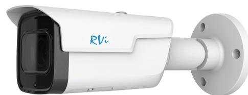
IP-камера RVi-CFG40/50M4/S rev. D1 оснащена моторизированным объективом 2.8-12 мм, который обеспечивает угол обзора 33°-94°. При этом максимальная дальность распознавания объектов составляет 39,8 метров.
