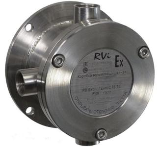
Окружающая среда может содержать взрывоопасные смеси газов и паров с воздухом категории I, IIA, IIB и IIC. Взрывозащищенная коробка из нержавеющей стали (12X18H10T) подходит для применения на объектах с агрессивной средой - химических и нефтехимических производств, а также для морских нефтяных и газовых добычных платформ, взрывоопасных зон морских портов и объектов с образованием соляного тумана.
